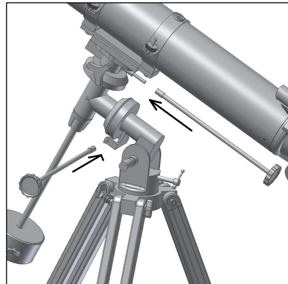
Abb. 7. Montage der flexiblen Wellen, Deklination und Rektaszension.
