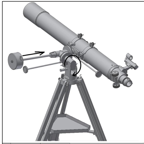
Abb. 10. Ausbalancieren des Tubus (Rektaszensionsachse).
